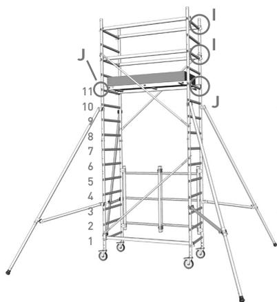
Positionner le plancher au maximum sur le 11ème barreau. Positionner les sous-lisses sur le 2ème barreau au-dessus du plancher et les lisses sur le 4ème barreau au-dessus du plancher.
